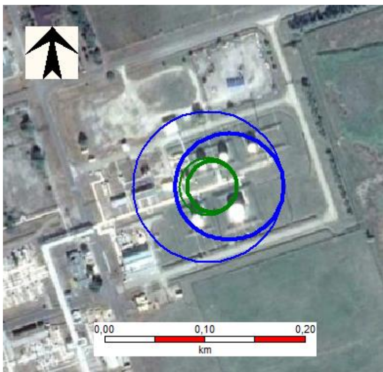
6.3.2.10.2.1. ábra A hőszugárzások hatótávolságai azonnali tócsatűz esetén B3 – Kőolaj folyamatos kiömlése a T-2001-es tartály DN200-as csővezetékéből a védőgödörön kívülre
