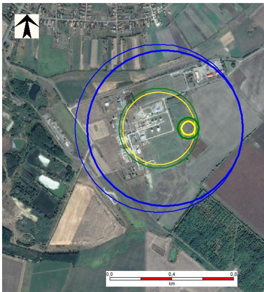
6.3.2.10.1.2. ábra Kései VCE nyomáshatásai a B1 – A kőolaj azonnali kiömlése T-2001-es tartályból a védőgödörbe
