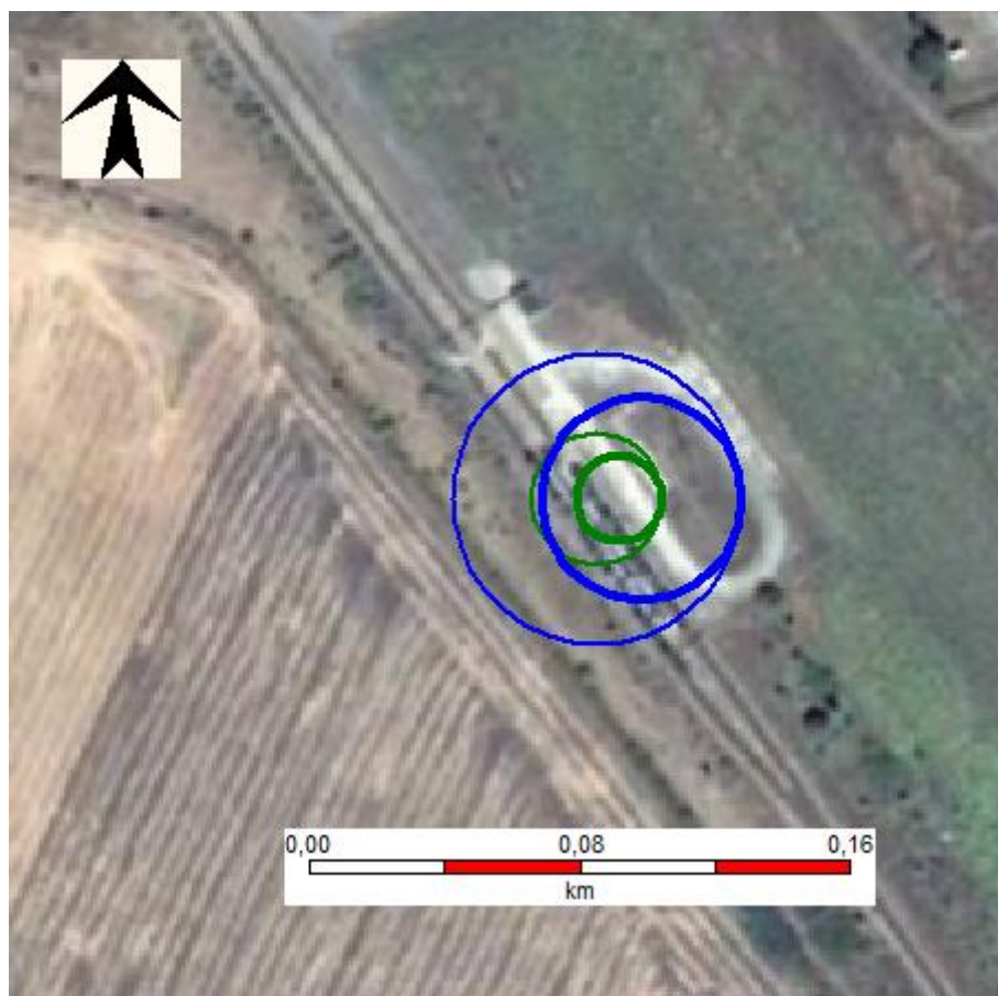
6.3.2.10.2.1. ábra A hőszugárzások hatótávolságai azonnali tócsatűz esetén L2 – Kőolaj folyamatos kiömlése a vasúti tartálykocsiból
